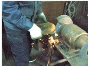
① 受入検査:割れ、刃カケ、溶着のチェック ②(刃カケ・溶着有)刃を全て落とす(スリコミ)
